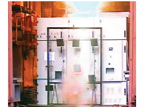
► Испытание КРУ серии КУ-10С на локализационную способность
