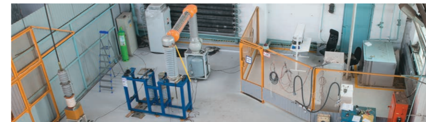
► Испытание КРУ серии КУ-10С на локализационную способность
