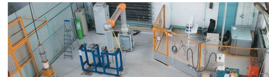
▶ Испытание КРУ серии KY-10С на локализационную способность
