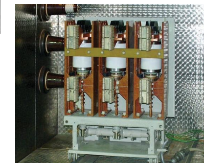
▶ Испытание выключателя BP3 в климатической камере
