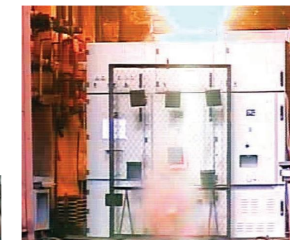
▶ Испытание КРУ серии KY-10С на локализационную способность
